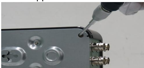
Открутите винты крепления крышки
